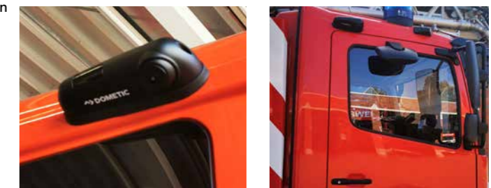
Anwendungsbeispiel: Feuerwehrfahrzeug mit CAM1000 Abbiegeassistenten-Kamera
